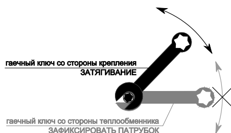
Рис. 5. Подключение к системе подачи теплоносителя
