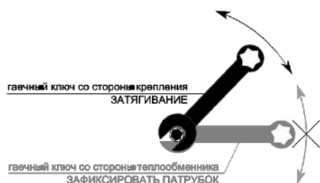
Рис. 5. Подключение к системе подачи теплоносителя.
