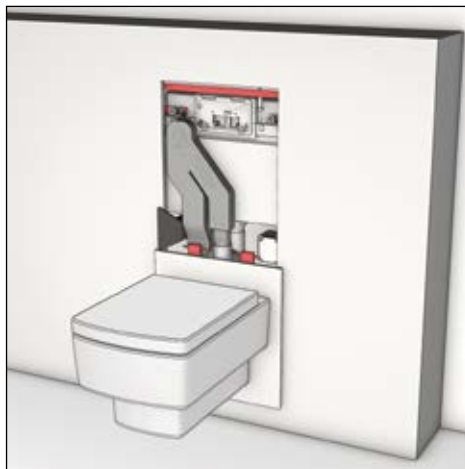
(5) Монтаж нижней стеклянной панели и унитаза.
