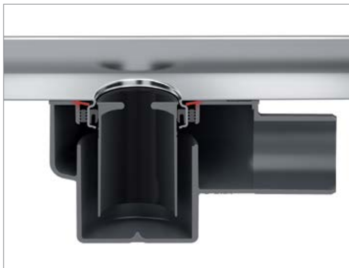
Оптимизированная конструкция сифона в разрезе.
