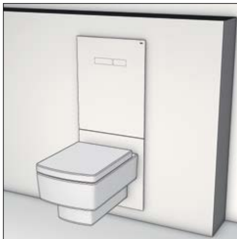
(6) Монтаж верхней стеклянной панели. Сборка завершена.
