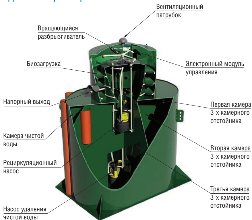
Рисунок 2. Схема станции Alta Bio со встроенным колодцем для сбора очищенной воды и напорным выбросом
