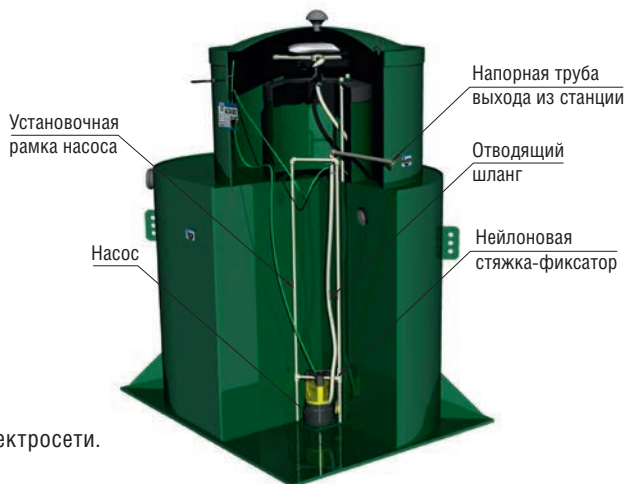
Рисунок 16. Установка насоса удаления воды камеры чистой воды
