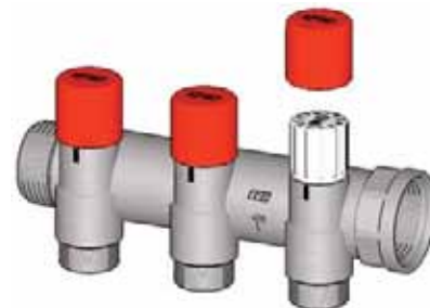
Рис. 25. Установка защитного колпачка
