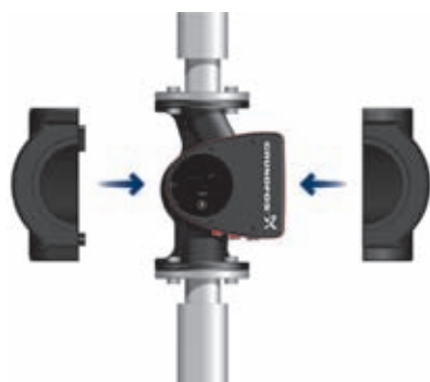
Рис. 24 Установка теплоизоляционного кожуха на насос MAGNA1
