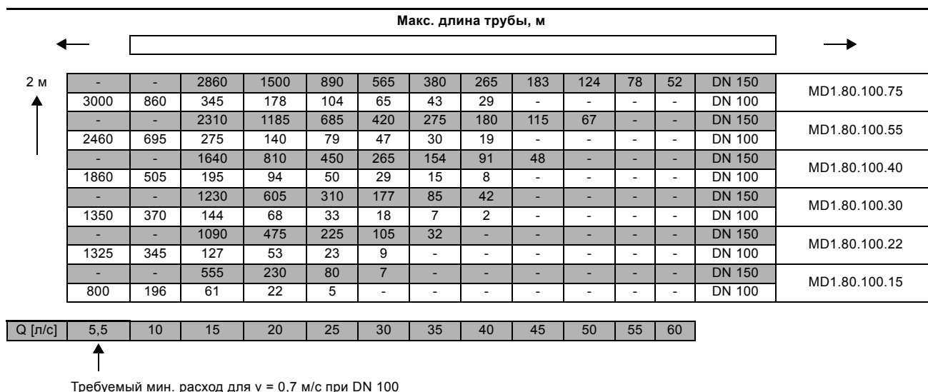
Рис. 34 Максимальная длина вертикальных или горизонтальных напорных трубопроводов
