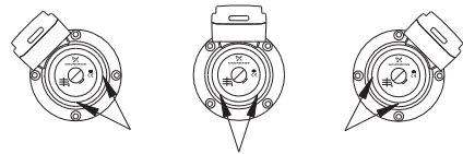
Рис. 5 Расположение клеммной коробки у одинарных насосов
