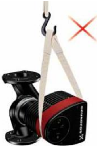
Рис. 10 Неправильный способ строповки насоса
