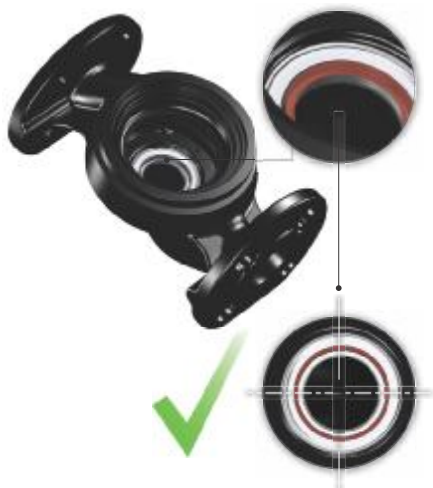
Рис. 16 Правильно выровненная система уплотнений.
