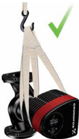
Рис. 10 Правильный способ строповки насоса
