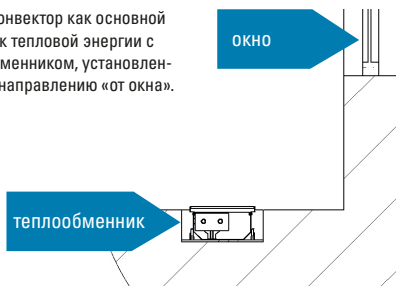
РИС. 3: Конвектор как дополнительный источник тепловой энергии с теплообменником, установленным по направлению «к окну».
