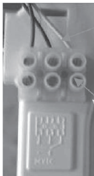
БӨЛМЕЛІК ТЕРМОСТАТТЫ ҚОСУ/ АЖЫРАТУДЫҢ КЛЕММДІК ҚАЛЫБЫ
