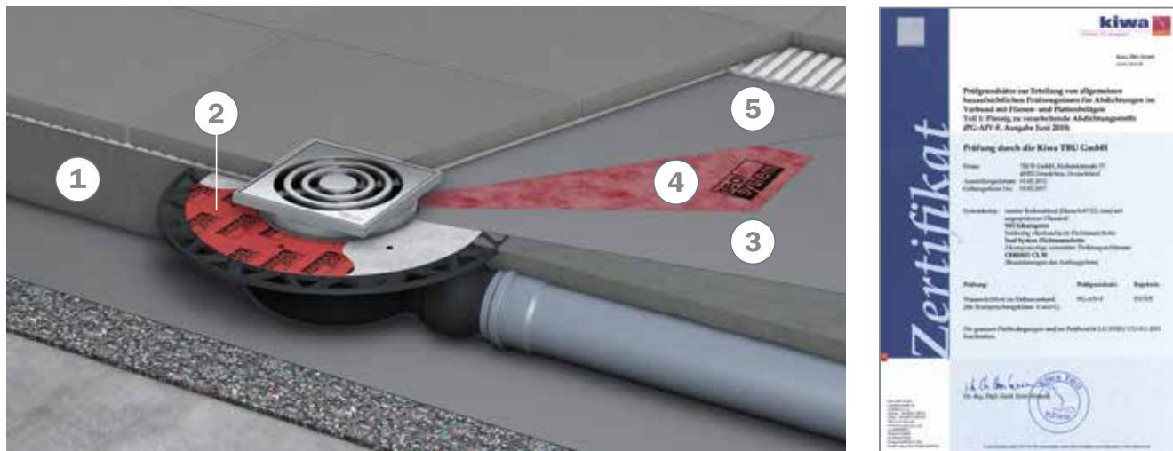
Технология Seal System для точечных трапов: стяжка (1), фланец сифона (2), гидроизоляционная манжета Seal System (4), композиционная гидроизоляция (3, 5)
