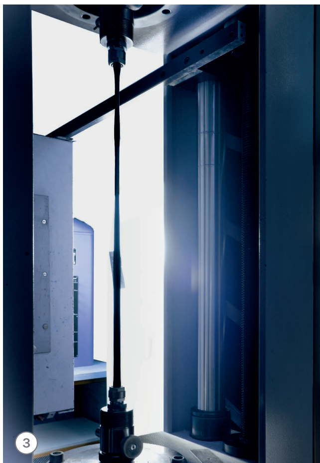
(1) Установка для проверки прочности соединения труб, (2) 3D сканер для проверки фитингов TECElogo, (3) Испытание трубы TECElogo на растяжение.
