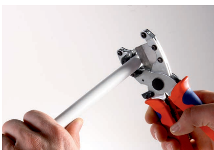
Обрезаем трубу при помощи труборезных ножниц...
