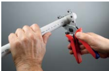
Отрезание трубы при помощи труборезных ножниц
