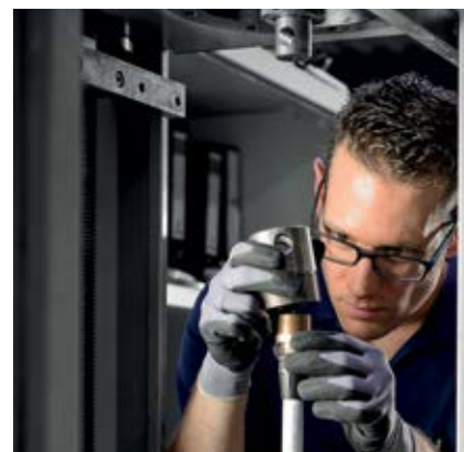
Подготовка для испытания на растяжение
