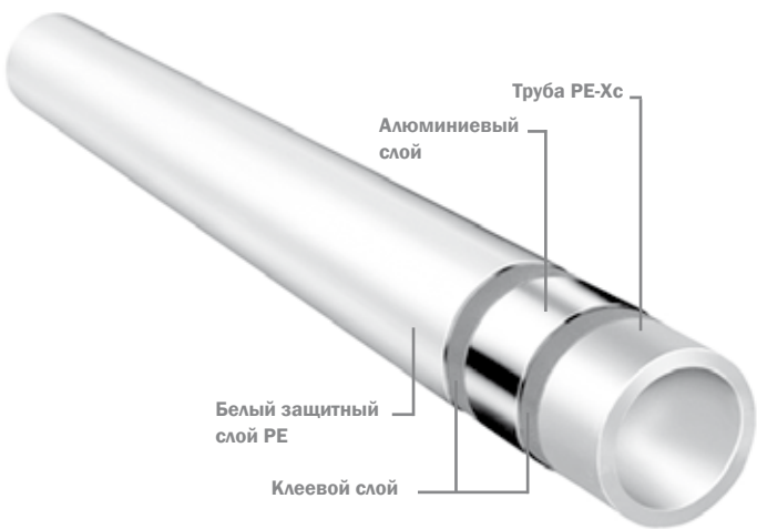
Структура универсальной многослойной трубы TECLogo
