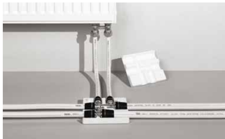
Подключение радиатора с использованием двойного тройника
