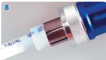
8 Расширьте трубу с кольцом до тех пор, пока торец трубы не упрется в торец расширительной головки
