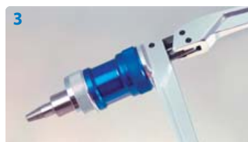
3 Прикрутите к насадке-вращателю расширительную головку Q&E
