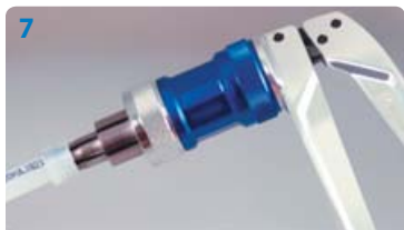
7 Выньте сегменты головки из трубы и повторите операцию расширения. Внимание! Головка должна поворачиваться автоматически после каждого расширения. Вам не нужно поворачивать сам инструмент. Количество расширений не должно превышать максимально допустимого
