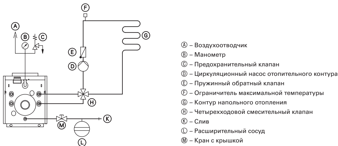
Рис. 4.3. Котел с четырехходовым смесительным клапаном
