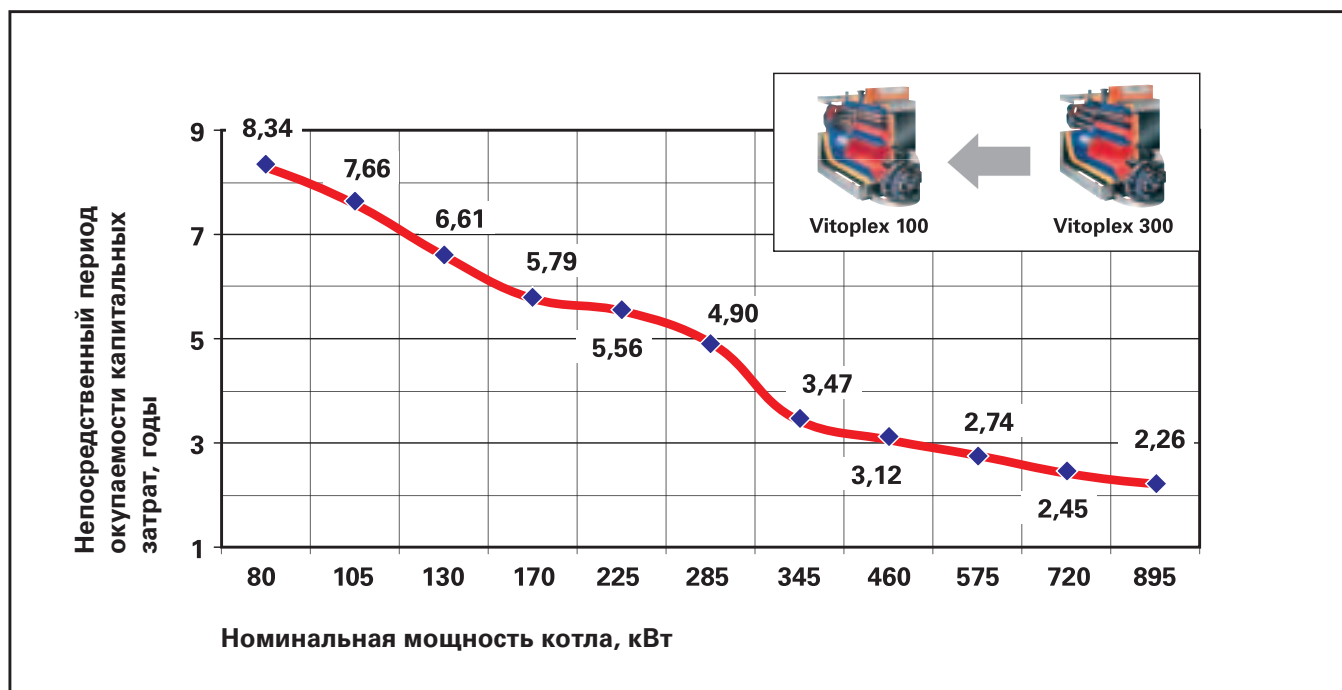
Рис. 13.10 Непосредственный период окупаемости Vitoplex 300 по сравнению с Vitoplex 100
